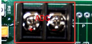
此接口用于测量电压，请正确连接被测信号线，并保证被测电压不要超过 12V。
