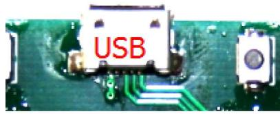
USB 接口用于模块和电脑通信，电脑可以通过此接口设置模块的相关参数配置，此接口是模块通过 CH340 芯片将 UART 转换成 USB，所以在使用 USB 接口前要安装相关的驱动软件，在使用时需选择正确的 COM 端口，并选择正确的通信方式速率（默认为 11520 波特率，8 为数据，无校验，1 位停止位）。
