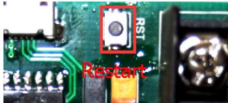
按下此键模块系统将重启，当模块电池上电时，由于电压不稳定，可能导致模块不能正常启动，此时你可能需要重启系统，或者模块处于睡眠状态，也可以通过重启系统唤醒模块。
